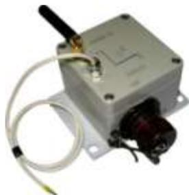
АДМВ-02 разработан по Техническому заданию Компании "D un D centrs", Латвия, Рига и предназначен для мониторинга состояния строительных конструкций, зданий и сооружений по ISO 4866 : 2010.
