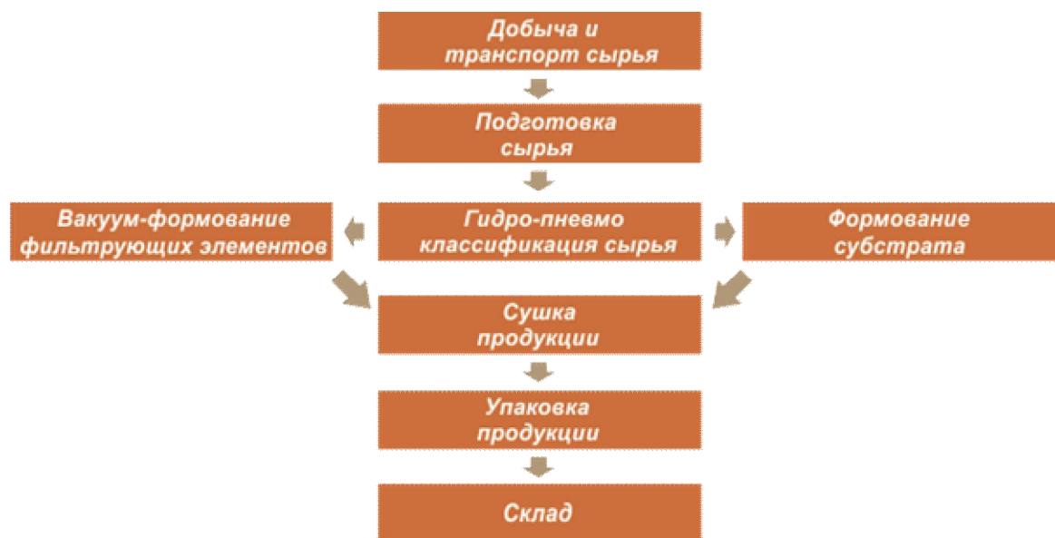
Рис. 2. Структурная схема технологической линии безотходной комплексной переработки торфяного сырья
