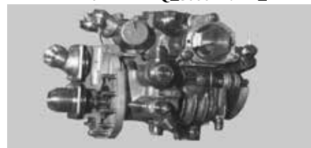
ШЕСТЕРЕННЫЕ Q \leq 3 \text{ м}^3/\text{ч} N \leq 12\,000 \text{ мин}^{-1}
